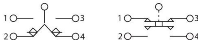
Рисунок 3. Принципиальные электрические схемы путевых выключателей полумгновенного и прямого действия.
